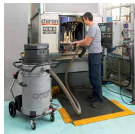
Aspirazione di olio e trucioli da macchina CNC.
