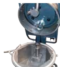
Testata basculante per una semplice rimozione di cestello e contenitore
