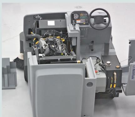
La manutenzione della SW8000 è facile e veloce, tutte le parti sono removibili senza attrezzi. Accedere al motore e ai componenti idraulici è facile, per risparmiare tempo e ridurre i costi di manutenzione.
