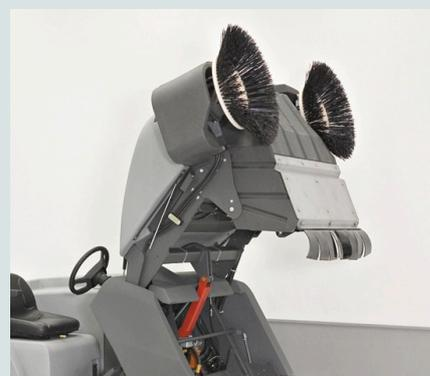
Lo scarico del contenitore della SW8000 raggiunge un'altezza massima di 152 cm. Grazie all'ampia visibilità della postazione, l'operatore ha il pieno controllo dell'attività di scarico del contenitore.
