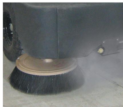
L'esclusivo sistema di abbattimento delle polveri ad acqua nebulizzata abbatte le polveri sollevate durante l'attività di spazzamento attraverso ugelli posizionati sulla/e spazzola/e laterali.
